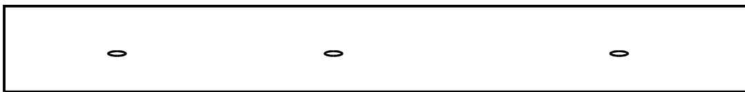
Пример 3 — три несплошности длиной по 3,2 мм
